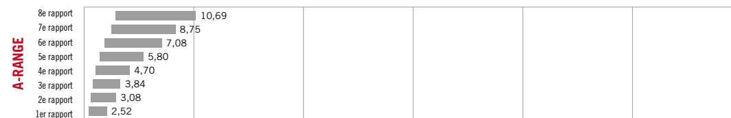
Transmission ActiveDrive 8 - Powershift 24 AV x 24 AR, 8 rapports [km/h]
