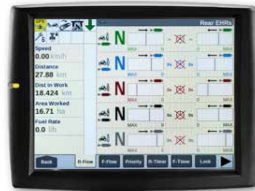
Vue d'ensemble des paramètres de débit et de temporisation sur le moniteur AFS Pro 700™.
