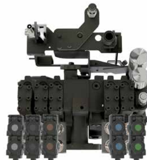
Bloc distributeurs AR 5 distributeurs EH maximum et alimentation extérieure Power Beyond
